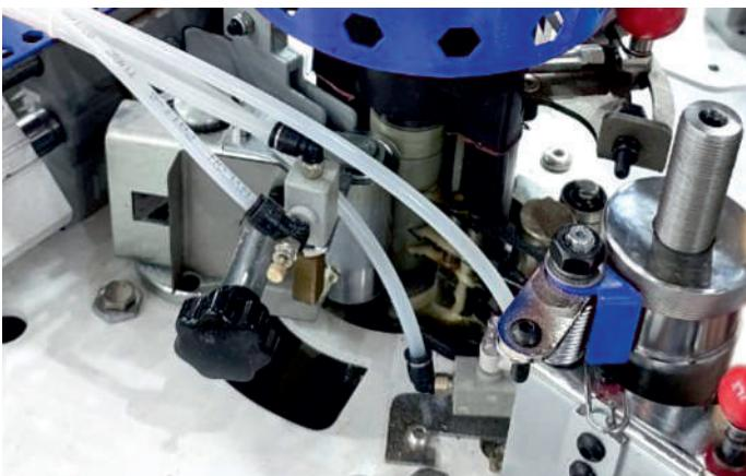
Для получения максимально качественного результата приклейвания кромки станок оборудован форсунками для подачи разделительной жидкости в зону контакта плоскости заготовки и свеса кромки.
